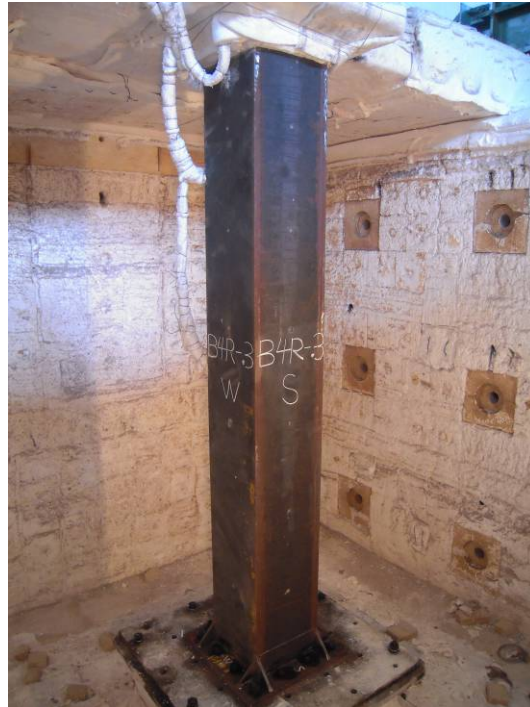
照片1：實驗前試體安裝(I)
