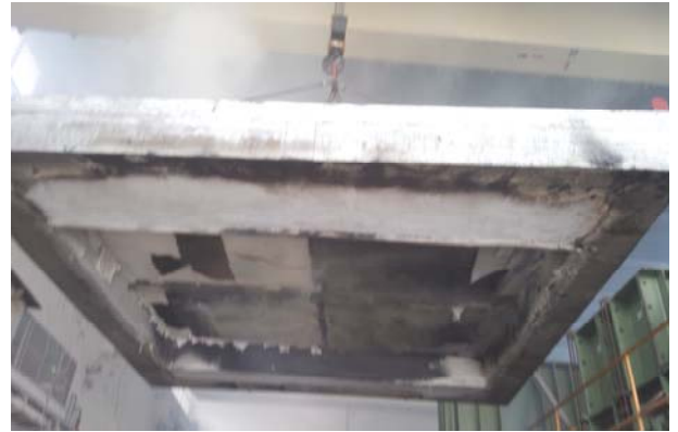
圖 14 第Ⅲ-A、Ⅲ-B、Ⅲ-C、Ⅲ-D 組試體進行加熱實驗後加熱面
