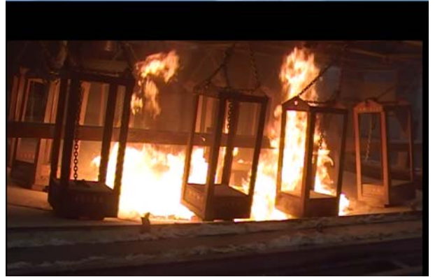
圖 9 第 I 組試體合板燒穿火焰竄出
