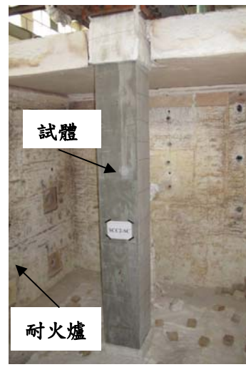
圖4 試體、加載設備與耐火爐裝置
