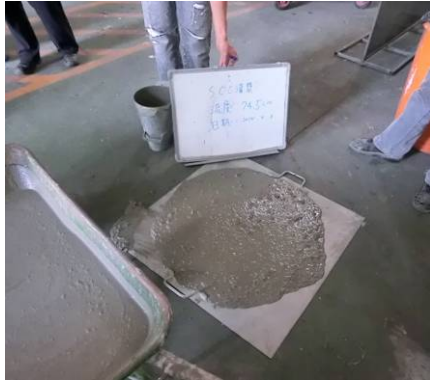
(a) 自充填混凝土流度試驗
