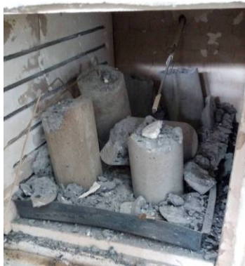
圖 11 自充填混凝土爆裂情形(未烘乾)
