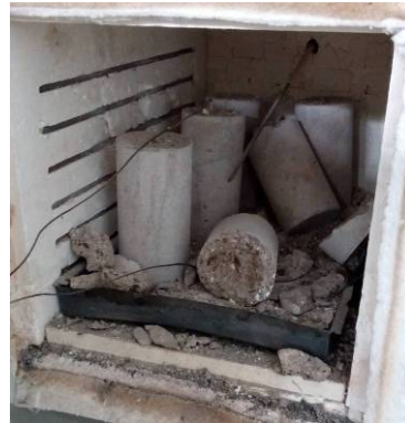
圖 12 自充填混凝土爆裂情形(烘乾 7 天)
