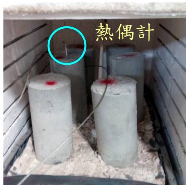
圖 6 加熱試驗時試體配置情形
