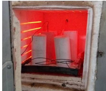
圖 7 圓柱試體自然冷卻方式
