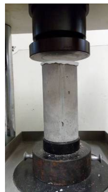
圖 9 圓柱試體抗壓試驗
