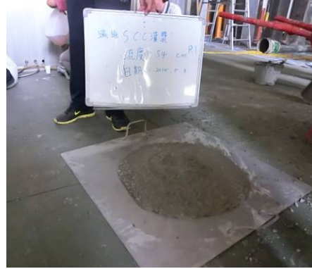
(b) 自充填聚丙烯纖維混凝土流度試驗
