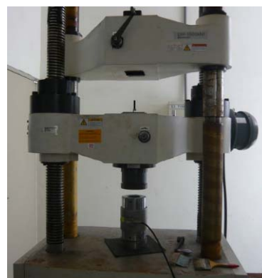
圖 5 SHIMADZU 100 噸試驗機
