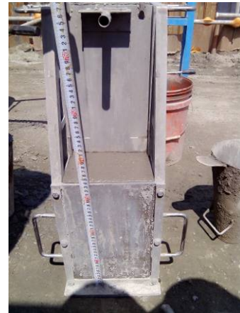
(c) U 型試驗填充高度
